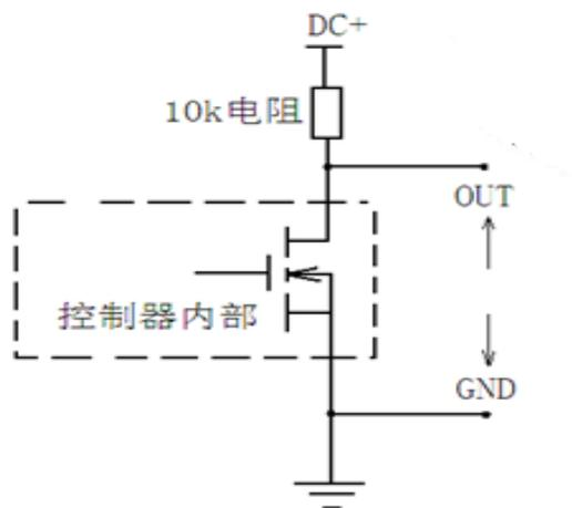
控制器提供2路数字输出量输出①，⑭，该端子为MOS管漏极开
