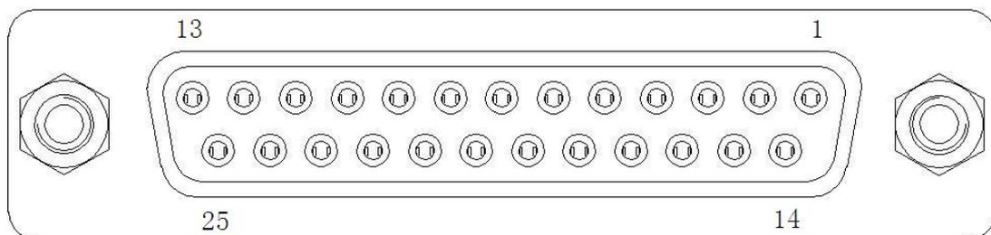
端子 ②①、②③ 为编码器提供工作电源，编码器的两相输出正交信号 A+、B+ 作为输入反馈信号直接连接到控制器的端子 ②①、②② 上。
